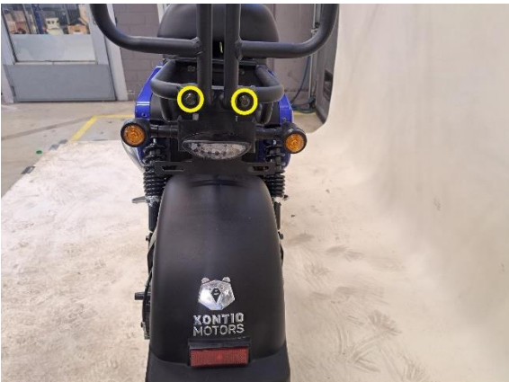
Irrota selkänöjan ja takavalon kiinnikkeen kiinnityspultit (kiintoavain 10 mm).
