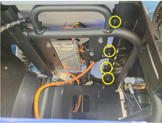
Irrota istuimen vasemmanpuoleisen alasivumuovin kiinnitysruuvit (ristipäämeisseli ph2).
