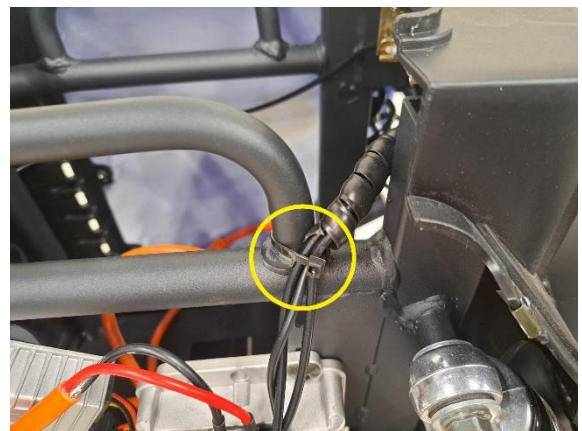
Katkaise takavalojen johtoja kiinni pitävä nippuside (sivuleikkurit).
