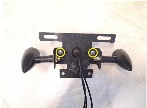
Irrota takavalon kiinnitysmutterit takavalon kiinnikkeestä (kiintoavain 7 mm).
